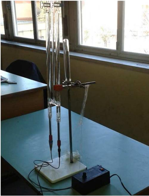
Per dimostrare scientificamente e in modo interattivo che  $H_2O$  sta proprio a significare due atomi di idrogeno e un atomo di ossigeno, è stata utilizzata la macchina di Hoffman che, grazie all'elettrolisi, evidenzia che il volume dell'idrogeno è il doppio di quello dell'ossigeno.
